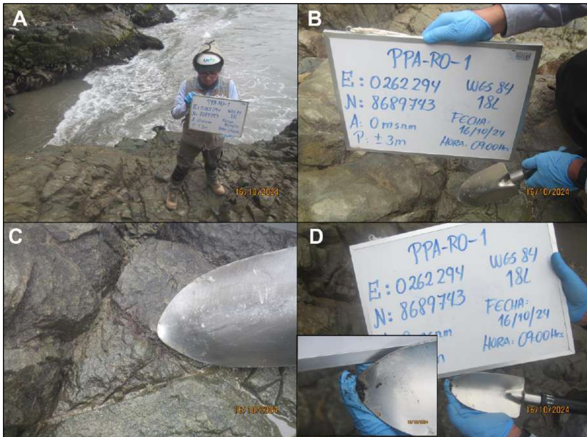
Figura 8.1. Potencial «foco de contaminación» en el sector norte de la formación costera Punta Pancha. A) Vista panorámica. B y C) Vista de la presencia de hidrocarburos impregnadas en las fracturas de las rocas D) Hidrocarburo con características de textura oleosa, color marrón oscura
